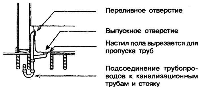
Рисунок 13-6 — Детали установки умывальника и ванны
